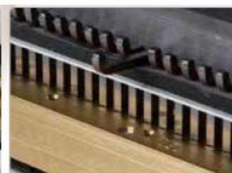
パンチツールは水平に装填します。ツールの交換は容易です。
